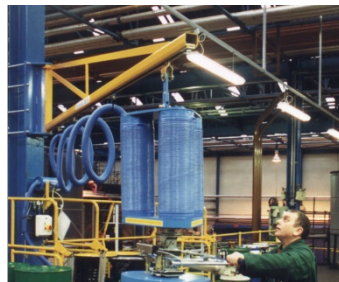
Der Vakuümheber ermöglicht einen sicheren Griff auf der Fassoberfläche
