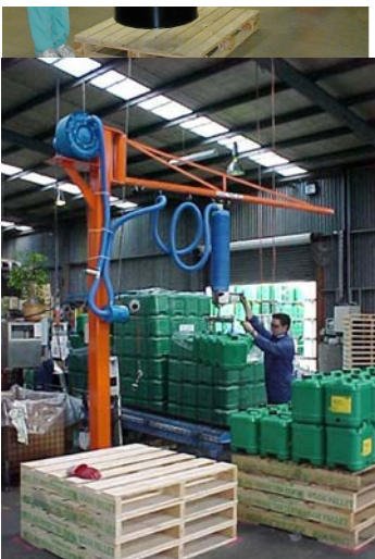
Vakuümheber ermöglichen die Handhabung von großen Fässern. Hier mit doppel-Schlauch Ausführung.
