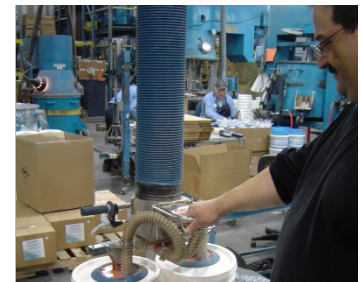
Der doppelte Saugfuß ermöglicht das Heben von mehreren Gebinden gleichzeitig.
