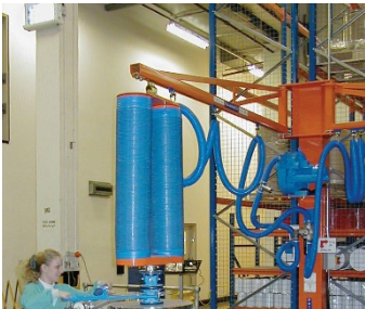
Vakuümheber ermöglichen die Handhabung von großen Fässern. Hier mit doppel-Schlauch Ausführung.
