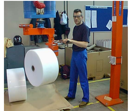
Das Heben von Coils mit einem Dorn, Doppelschlauch-Ausführung für schwere Lasten
