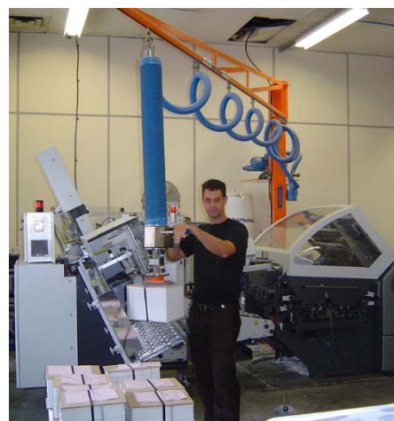
Heben und transportieren von Papierpaketen beim Beschicken einer Druckerpresse.
