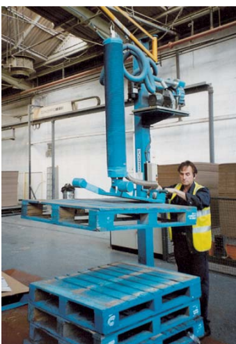
Heben und transportieren von Paletten. Der spezielle Griff ermöglicht eine 360° Rotation um eine Inspektion zu ermöglichen.
