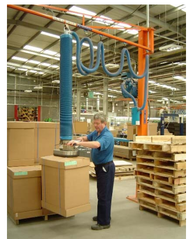
Heben von Kartons mit dem S-Line Saugfuß
