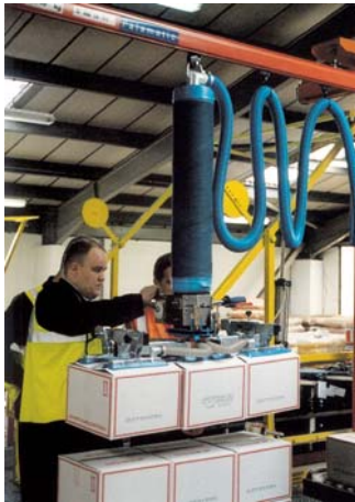
Heben und transportieren von mehreren Kartons gleichzeitig mittels mehrfach-Saugfuß
