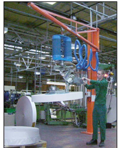
Mit Doppelschlauch Für das Heben von schweren Rollen
