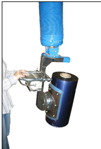
90° Drehvorrichtung Für das Aufrichten oder Ablegen von Rollen
