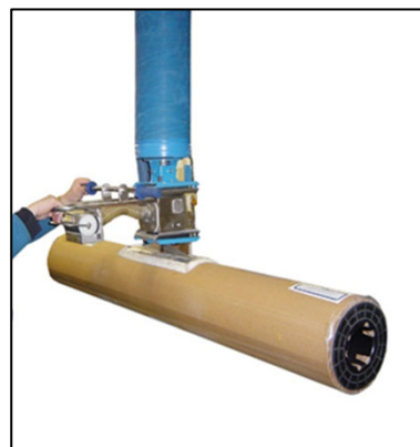
Transportieren von langen Rollen Mit angepasstem gebogenen Sauger
