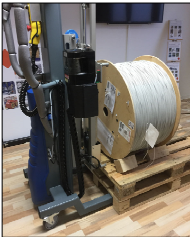
Kabelrollen Kombiniert mit elektronisch betätigtem Greifer
